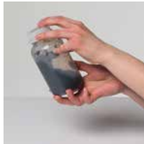
3) Extraktion durch mehrmaliges Schütteln
