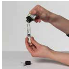
7) Zugabe einer definierten Tropfenzahl des Farbreagens
