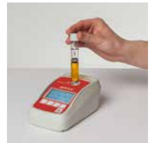
9) Einstecken der Messküvette in das AMOLA® Gerät und direktes Ablesen des Messwertes in z.B. kg/ha (Mineralböden) oder mg/l Substrat (Substrat) oder ...
